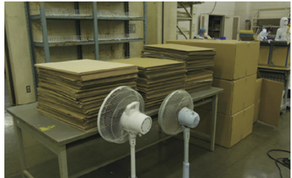
図14 エアストリーム法による乾燥
